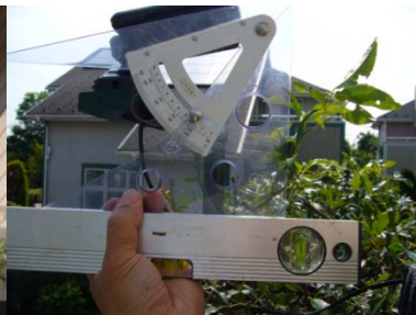
[図2 傾斜角度設定方法]
