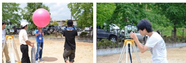
(図 5) 桃山高校によるパイボール気球観測の様子。30 分おきに気球を打ち上げ、その軌跡から上空の風向を観測した。
