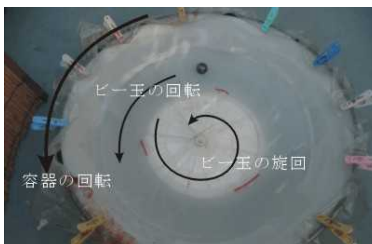
写真には、回転円盤上の円形容器（照明器具の傘）、容器内の水、水中で回転中のビー玉の3者が写っている。操作：容器を回転させ、水を剛体回転させる。容器の円周上で容器の円周速度を得たビー玉を放つ。ビー玉が水の回転方向に旋回しつつ、容器の中心方向に落下して行く。
